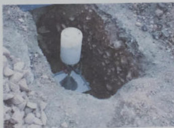
Рис. 9.6. Определение плотности грунта основания дорожной одежды с использованием пескозагрузочного бака
