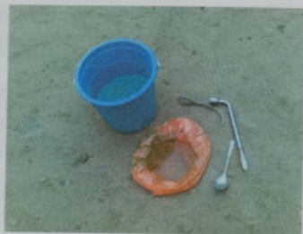
Рис.9.7. Контроль плотности укатанного слоя грунтовой подушки методом лунки с использованием воды
