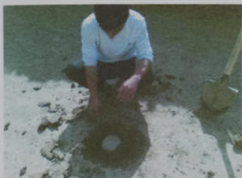
Рис.4.4. Отбор монолита грунта при контроле плотности укатанного слоя грунтовой подушки
