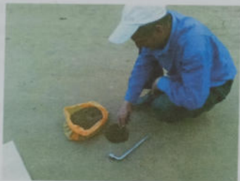
Рис.9.7. Контроль плотности укатанного слоя грунтовой подушки методом лунки с использованием воды
