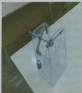
Рис.9.15. Прибор ПРГ-1 для определения размокаемости грунтов. 1- корпус, 2- опора, 3- качающаяся ось, 4- гайка, 5- стрелка, 6- рычаг, 7- гибкая связь, 8- сетка, 9- противовес, 10- шкала.
