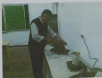
Рис. 4.7. Разделка монолита грунта на отдельные пробы и образцы
