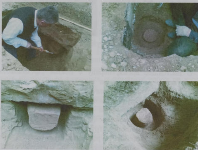
Рис.4.3. Отбор монолита грунта из-под фундамента
