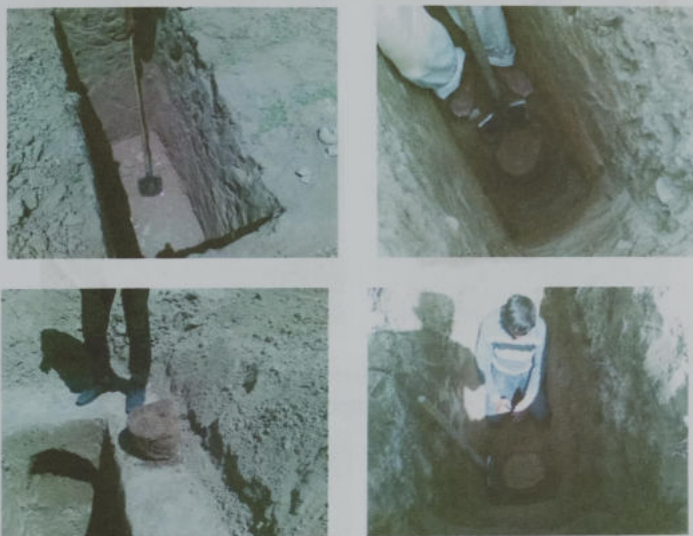
Рис.4.1. Отбор монолитов грунта со дна и стенки шурфа
